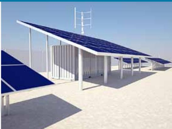
Procédé de traitement d'eau avec alimentation par production d'électricité photovoltaïque et éolienne.
